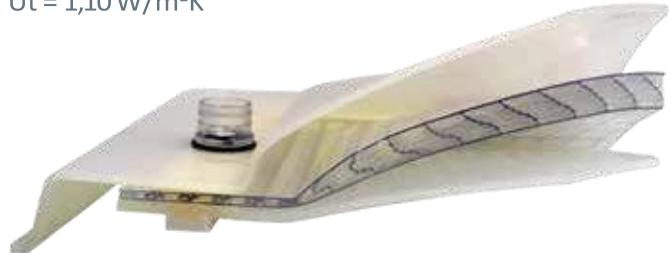
**VISS dvoslojna kupola** sa gornjom ljkuskom iz lijevanog akrila (prozirno, opal ili IRR-heatstop) ili punog polikarbonata te dvije varijante donjih slojeva u debljini 10 mm ili 16 mm iz višekomornog polikarbonata prozirne boje.
